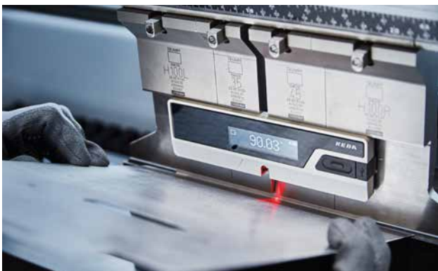
Automatisches Messen direkt an der Maschine
