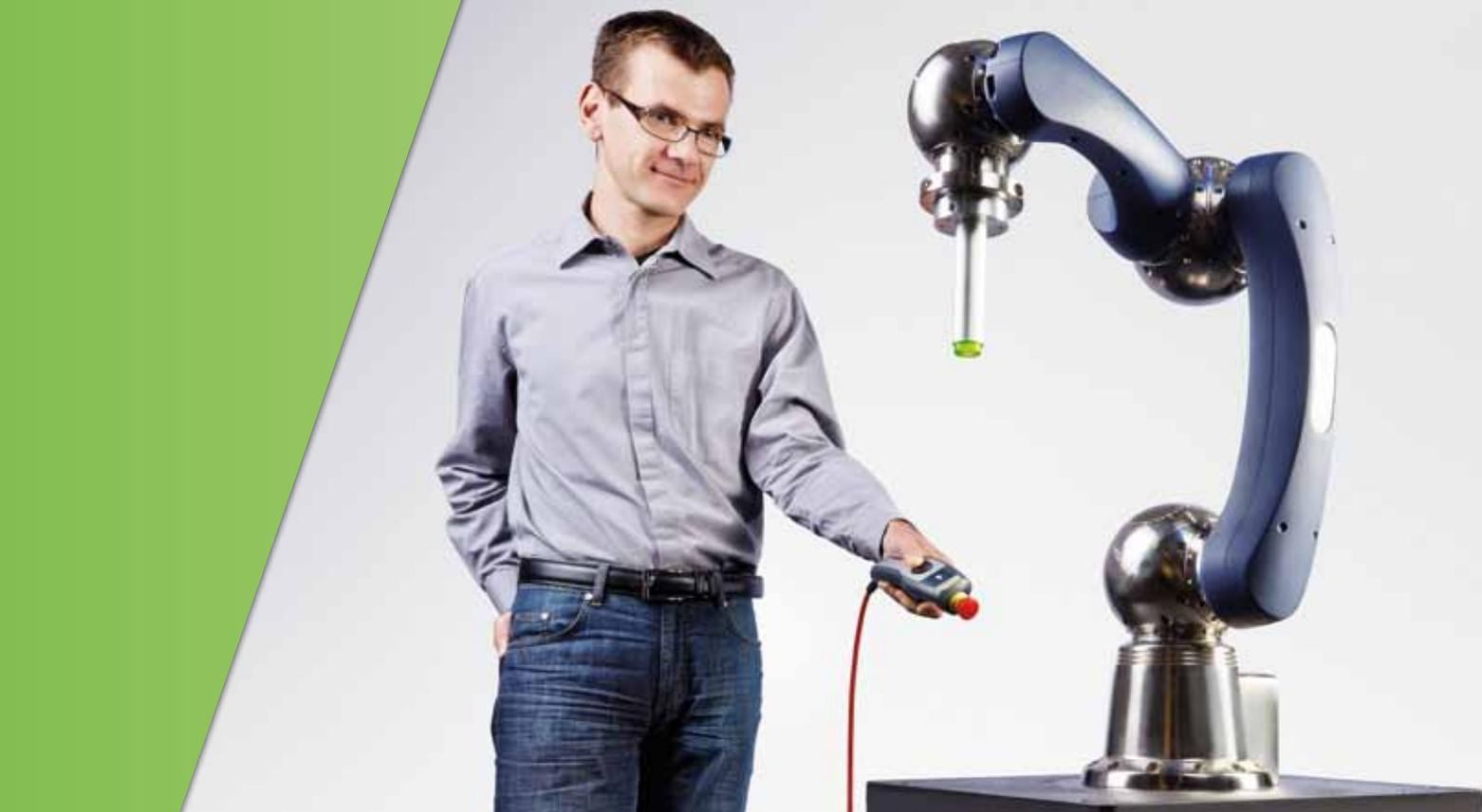
Im an einem Koordinatensystem ausgerichteten Modus werden die Richtungen durch ein gewähltes Koordinatensystem definiert (Welt / Objekt / Werkzeug). Die Bewegungsachse wird durch die Ausrichtung des KeTop T10 selbst gewählt und entspricht jener Achse des Koordinatensystem, die der zentralen Längsachse des KeTop T10 am nächsten ist. Diese Art des Joggens kann somit als eine Art „snap-to-grid“ Variante des freien Modus angesehen werden.
